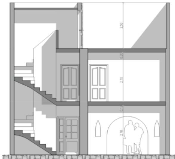
Figure 38 : Coupe A-A' d'une maison a Tafilelt. Source : Présentation de l'association Amidoul a l'EPAU.
