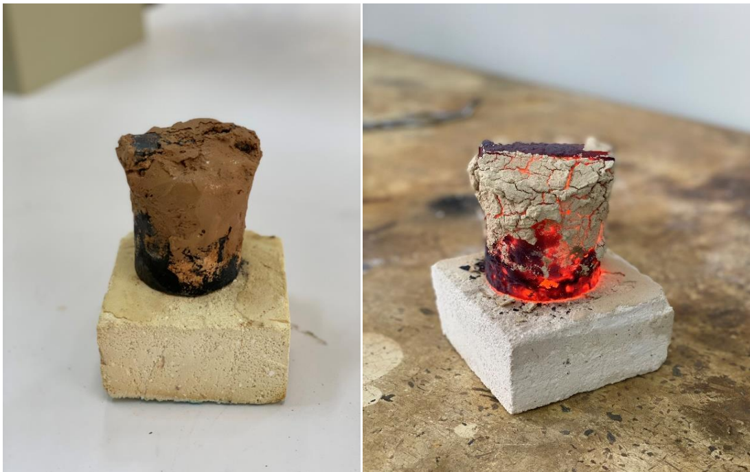
Figure III-5 b) Creuset préparé avant et après traitement
