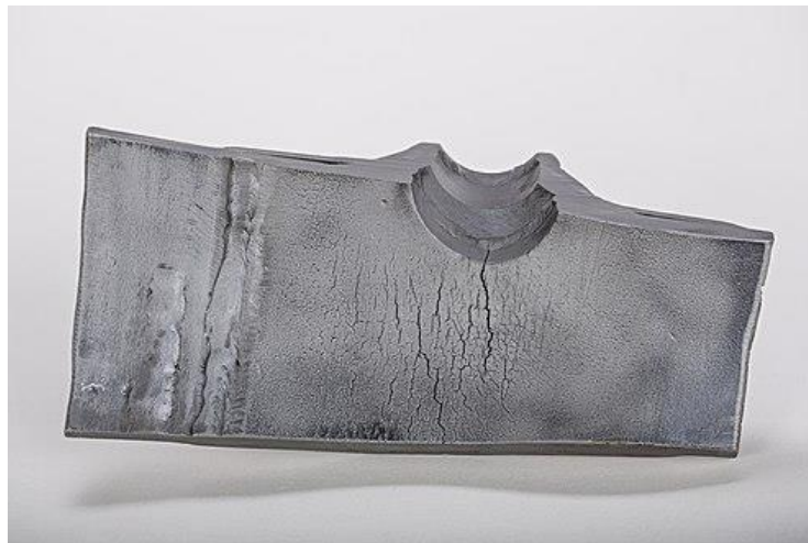
Figure I.10 : Corrosion sous contrainte[10].
