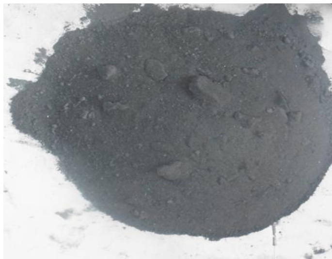
Figure III-4. Poudre de boruration- creuset cylindrique
