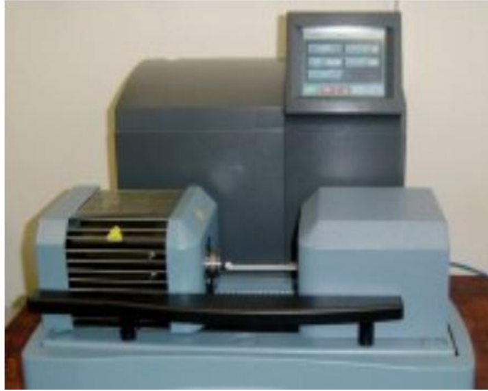
Fig. 47 : Appareil d'analyse thermique « SDT Q600 instrument »
