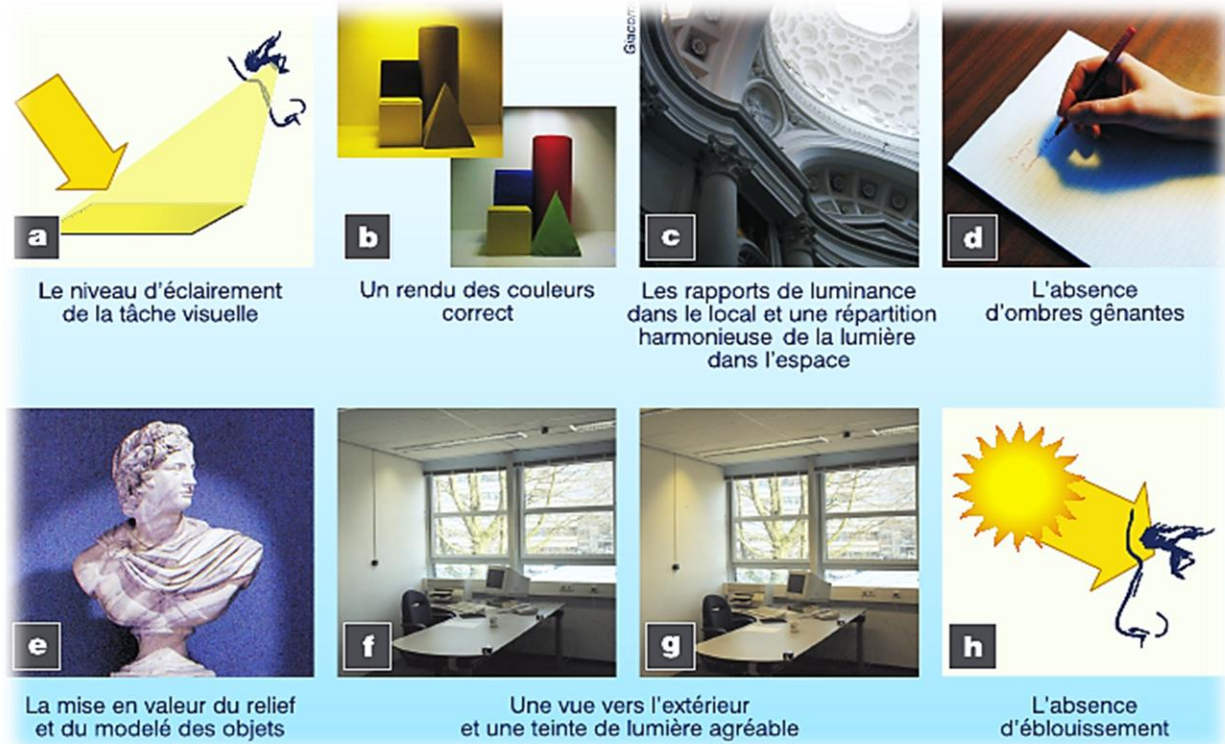
Figure VI(56): paramètre de confort visuel Source : Revue CSTC. le confort visuel et la normalisation
