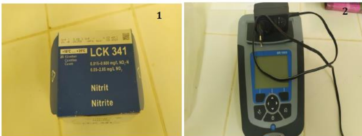
Détermination de Nitrite. 1 : Réactif Nitrite LCK 341. 2 : Spectrophotomètre DR 1900
