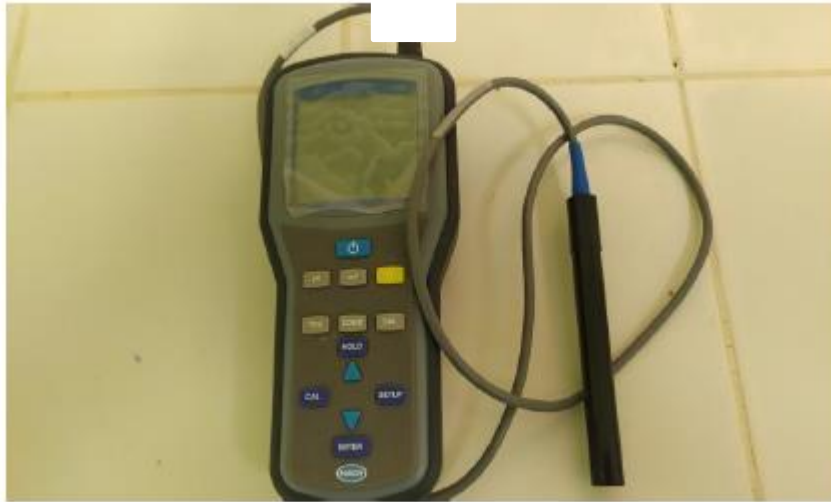
Mesure de la conductivité, la salinité et de température par conductimètre H170 HAC
