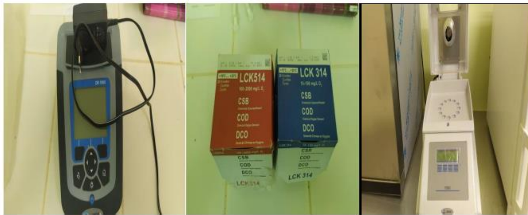
Détermination de la DCO. Spectrophotomètre et Réactif DCO, Réacteur DCO
