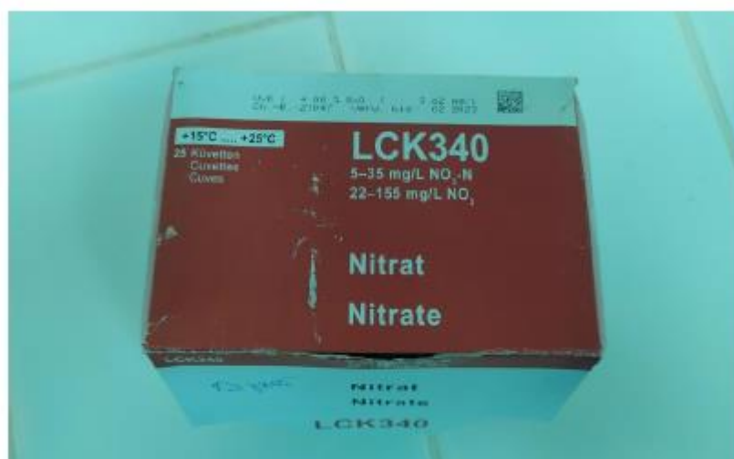
Détermination de Nitrate (Le réactif de Nitrate (LCK 340))
