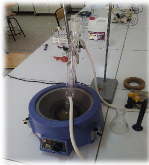
Photo 6 : Extraction des acides Réfrigérant à reflux (type BI).(Original,2016).
