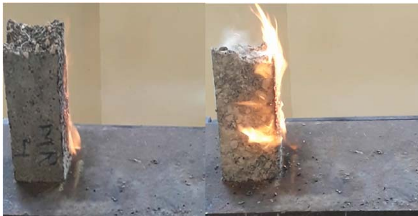
Figure III.28. Combustion d'échantillon pendant l'essai de la résistance au feu.
