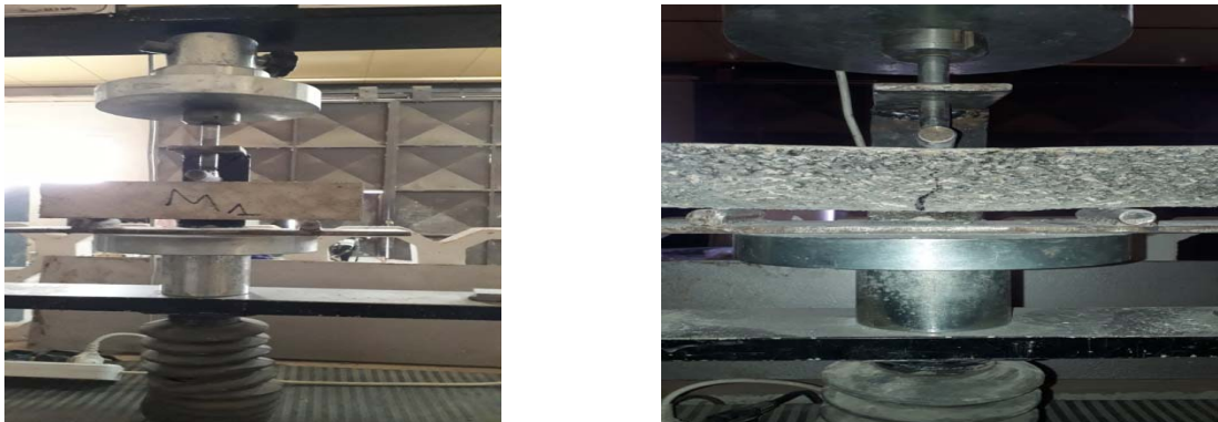
Figure III. 5. Eprouvette après rupture en flexion simple.
