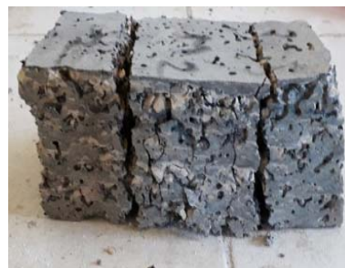
Figure III.19. Etat des éprouvettes de bétons à base de granulats de caoutchouc après l'écrasement
