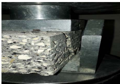
Figure III.19. Etat des éprouvettes de bétons à base de granulats de caoutchouc après l'écrasement
