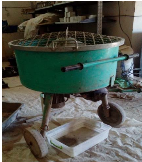
Figure II 10. Malaxeur de type batteur à axe vertical
