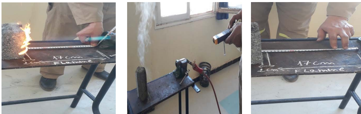
Figure III.11. Essai de résistance au feu.
