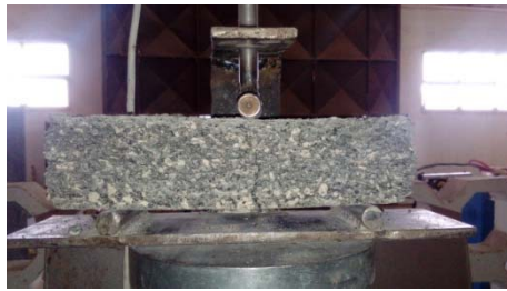
En cours de l'écrasement
