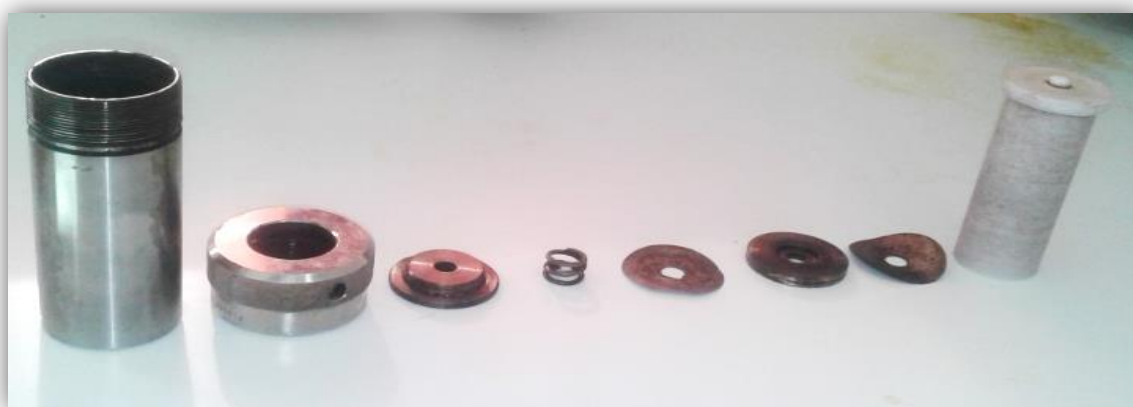
Figure (2) : Le corps en acier inoxydable et la chemise en téflon de l'autoclave.
