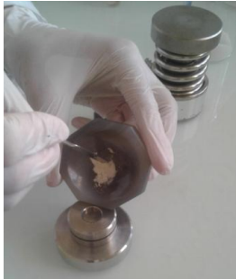
Placer notre poudre dans le moule
