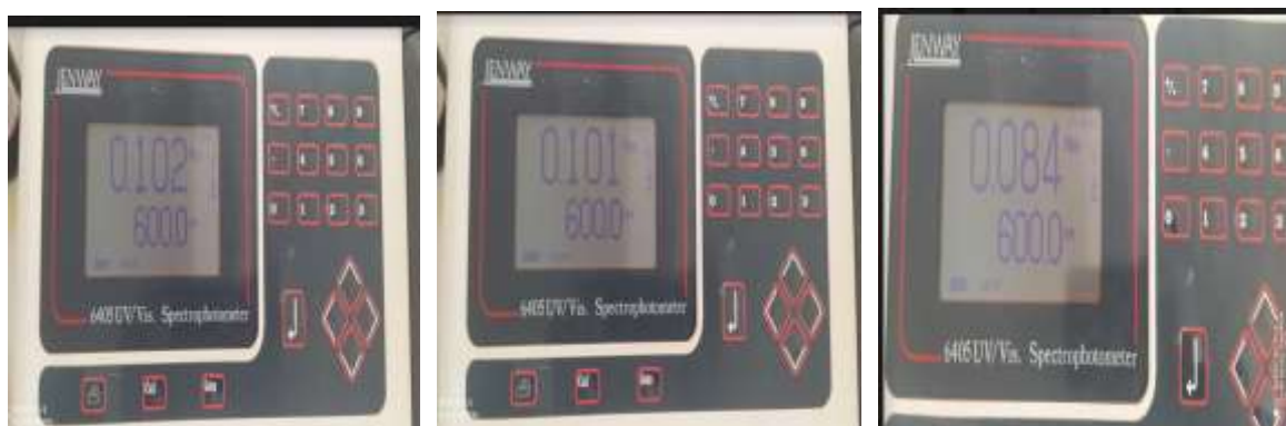
Figure 24. Spectrophotomètre de type Jenway 6405 UV/VIS (Essex, UK) (Photo originale, 2022).
