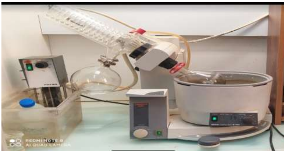
Figure 21. Evaporation de l'éthanol à 50°C dans un évaporateur rotatif de type Heidolph Rotary Evaporator, Laborota 4000 (Photo originale, 2022).
