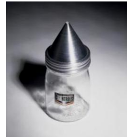
Figure II.3 : Mesure de masse volumique absolue avec la méthode de Pycnomètre
