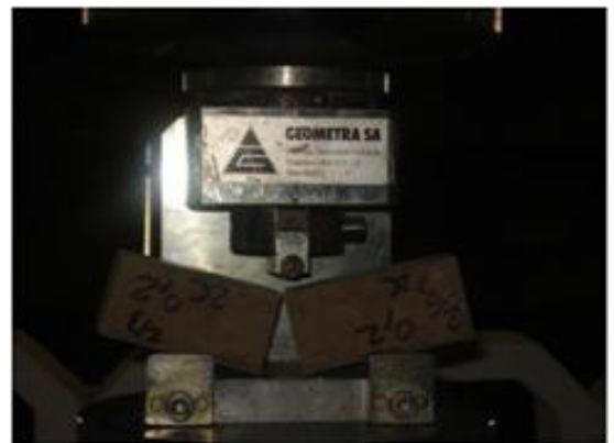
Figure II.9 . Presse utilisé pour essais de flexion
