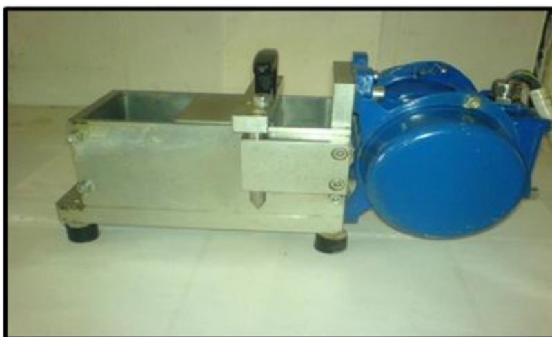
Figure II.7 : Maniabilimètre B (180x90x90mm).
