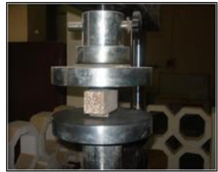
Figure II.10 . Dispositif de l'écrasement par compresseur Figure II.11 . Presse utilisé pour essais d'écrasements
