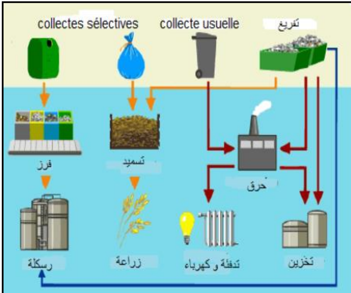
الشكل رقم 185: صورة توضح مراحل معالجة النفايات المصدر: من إعداد الطلبة
