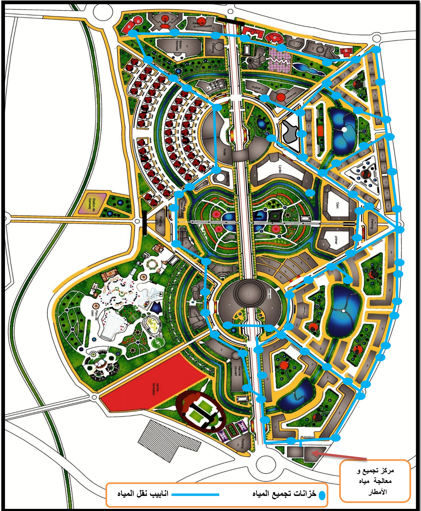
الشكل رقم 238: صورة توضح خزانات تجميع مياه الأمطار و الانابيب الناقلة لها . المصدر: من اعداد الطلبة
