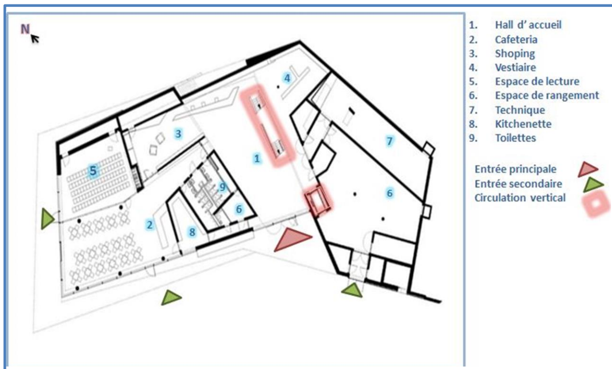
FIG. II(24) : PLAN RDC DU CENTRE .SOURCE ARCHDAILY
