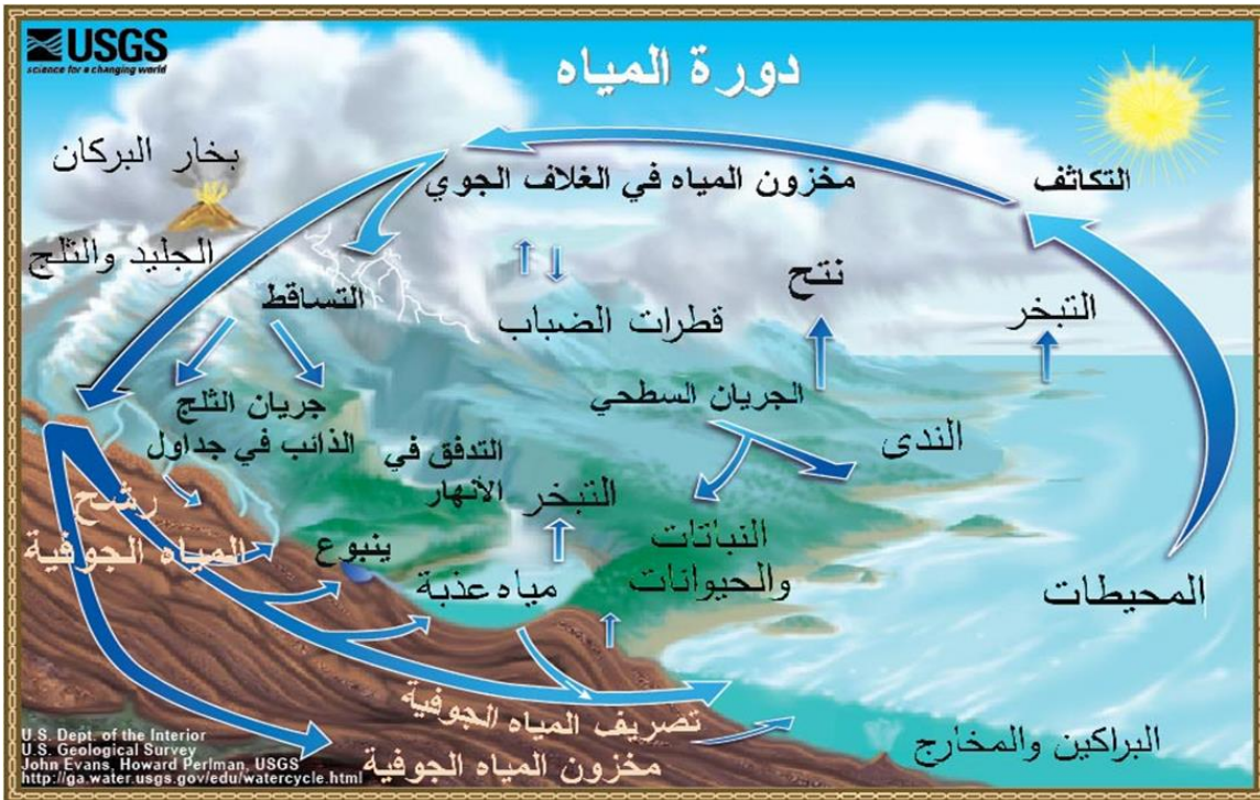
المخطط رقم (16) - توضح دورة المياه
