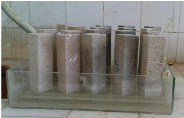
Figure II.24. Technique expérimentale utilisée dans l'essai d'absorption capillaire
