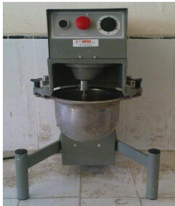
Figure II.10. Malaxeur normalisé pour pâte et mortier
