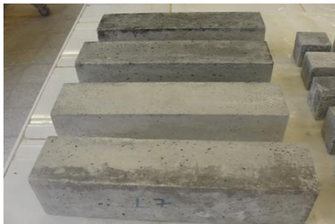
Figure II.12. Éprouvettes prismatiques (40x40x160) mm 3
