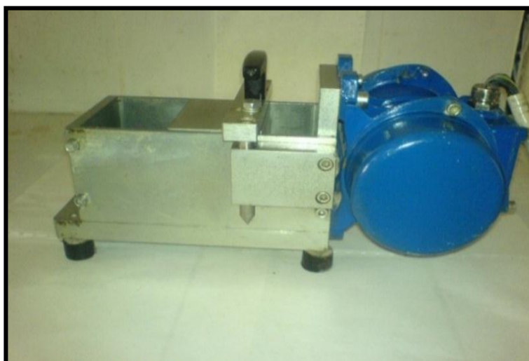
Figure II.11. Maniabilimètre LCL «B» utilisé pour la mesure de la maniabilité
