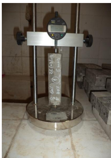
Figure II.13. Rétractomètre muni d'un comparateur de mesure de la variation de longueur
