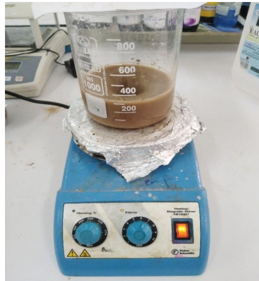
Figure.09 :Préparation la solution du sol (Belhmari. 2024)
