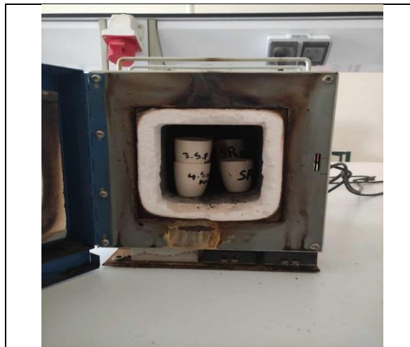
Figure15 :Matériel utilisé pour les mesures de matières organique (Belhmari. 2024).
