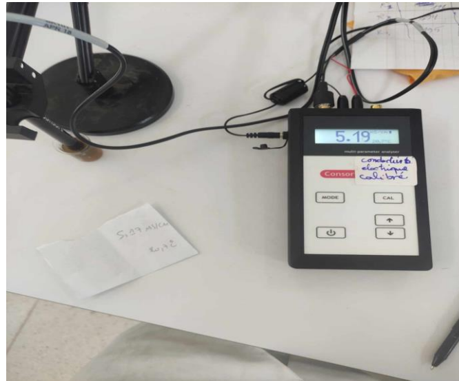
Figure.11: Mesure de la conductivité électrique (CE) (Belhmari. 2024)
