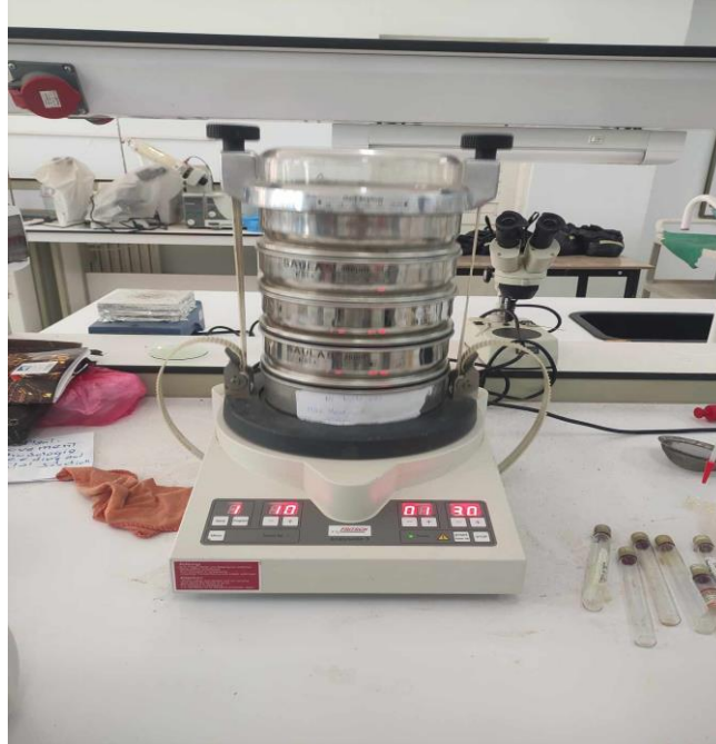
Figure.13 : Représentation du matériel utilisé pour l'analyse granulométrique (Belhmari. 2024)
