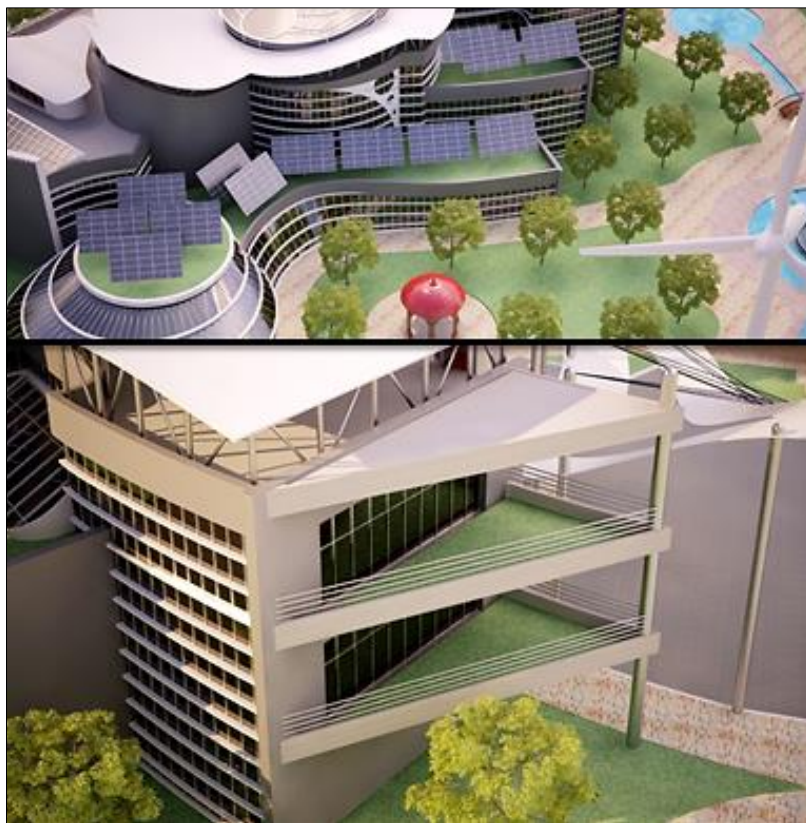
Figure 65 : la toiture végétalisée du projet
