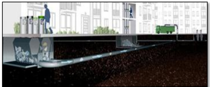
Figure 87 : Le dépôt dans les locaux techniques en sous-sol.
