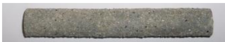
(c) Surface de barre revêtue de sable
