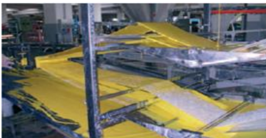
Figure 2.17 : Imprégnation de la résine
