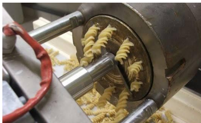
Figure 2. Procède d'extraction des pâtes alimentaires (Simon, 2016).
