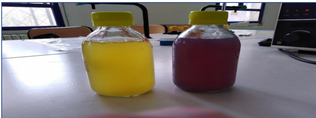
Figure 28 : Deux milieux de (GNU-BCP) à gauche acide a PH 5.2 de couleur jaune et à droite neutre a PH 6.8 de couleur pourpre.
