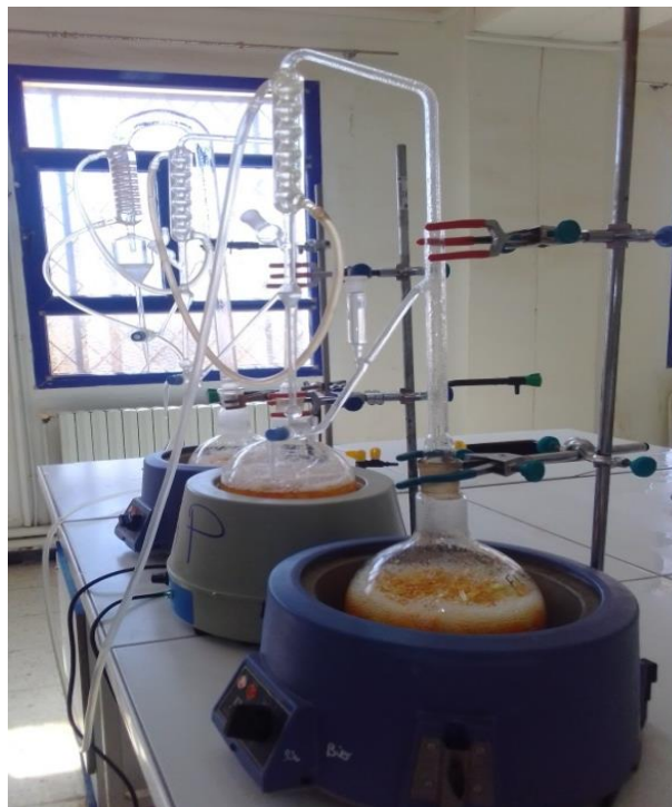
Figure 16: Montage de l'hydrodistillation (Batterie de trois appareils de type Clevenger)
