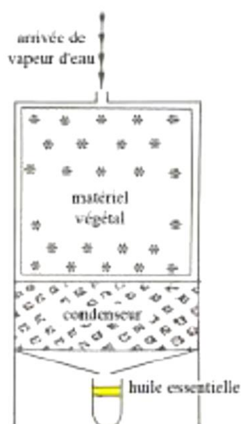
Figure 6: Schéma explicatif d'hydrodiffusion (Lucchesi, 2005)
