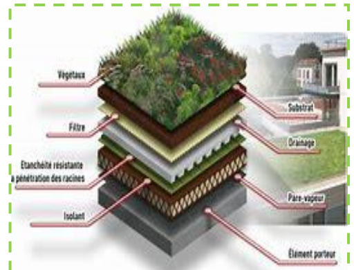
Figure 181 technique de toiture végétalisée
