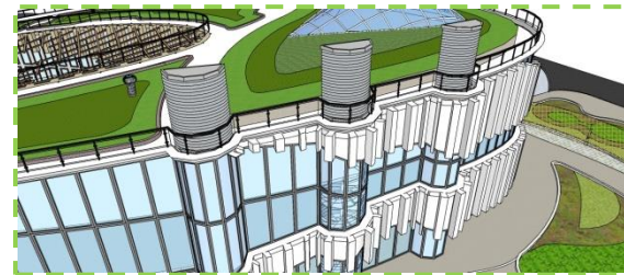
Figure 190 Façade double peau. Source : Auteurs
