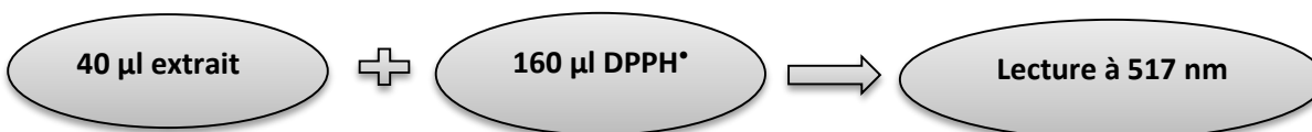
Schéma III.1. Mode de remplissage de la plaque pour chaque échantillon (inhibition de DPPH • )
