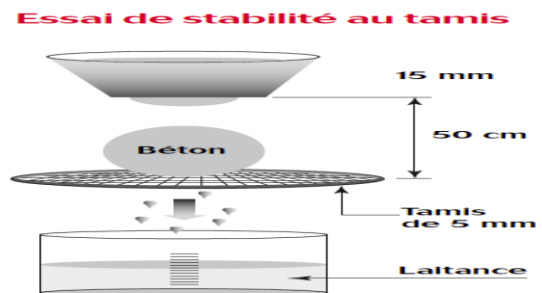
Figure 2.5: Essai de stabilité au tamis.
