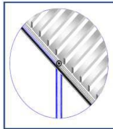
Figure 175: utilisation des gargouilles pour le réseau de drainage bois- Source : Auteur
