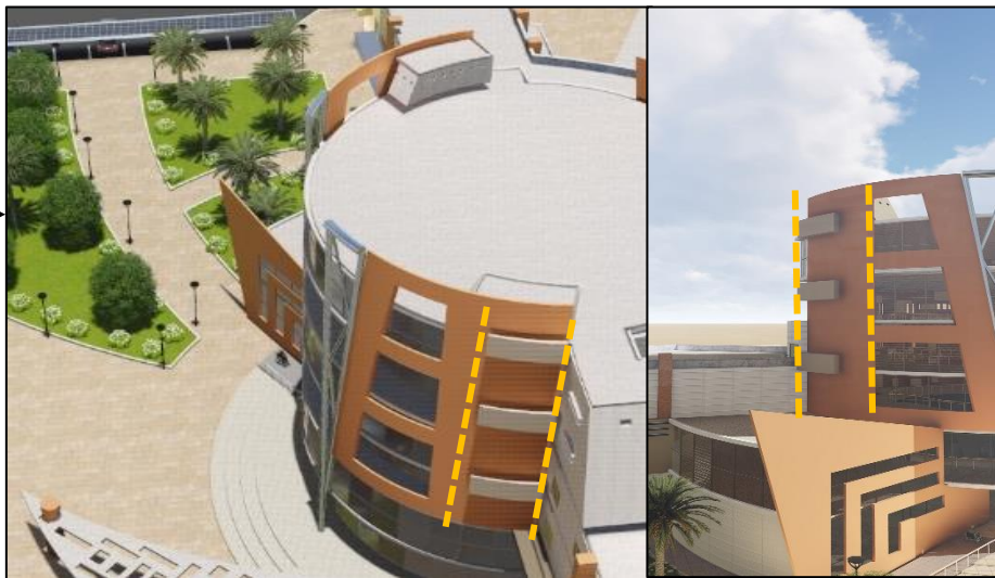
Fig207 : l'intégration des gaines par des élément en pvc Source : Auteur
