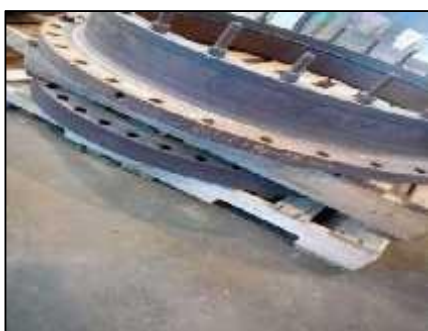
Figure I.14 : les anneaux de test côté boîte de distribution et côté tête flottante
