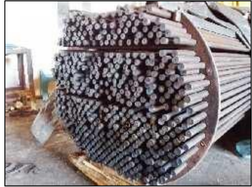
Figure I.16 : insertion des nouveaux tubes
