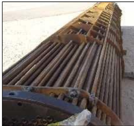
Figure I.10 : Faisceau tubulaire de l'échangeur.
