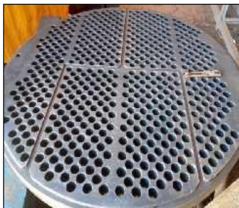
Figure I.7 : Plaquette tubulaire de l'échangeur.
