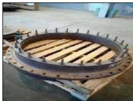
Figure I.14 : les anneaux de test côté boîte de distribution et côté tête flottante
