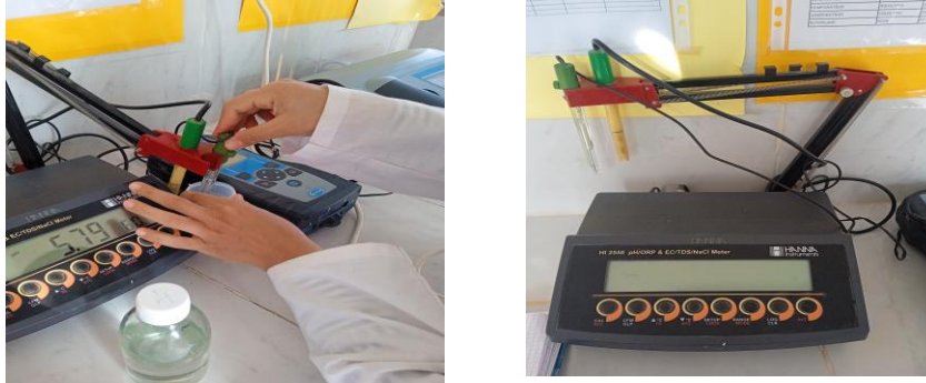
Figure II.13 : mesure du PH (Originale, 2025).
