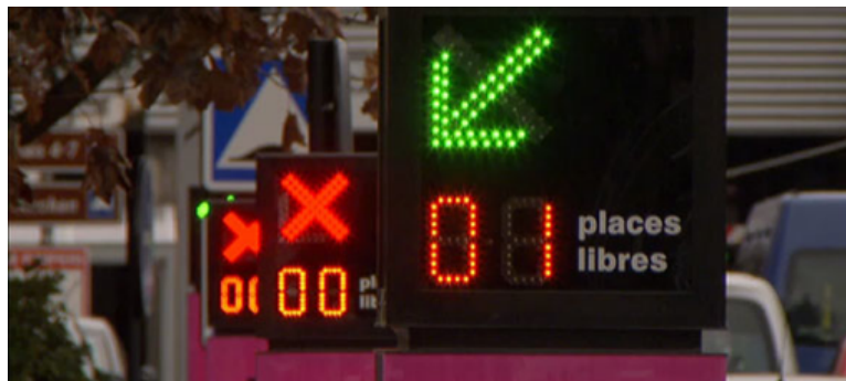
Figure 3.8: Parking géré par un système de comptage [17].
