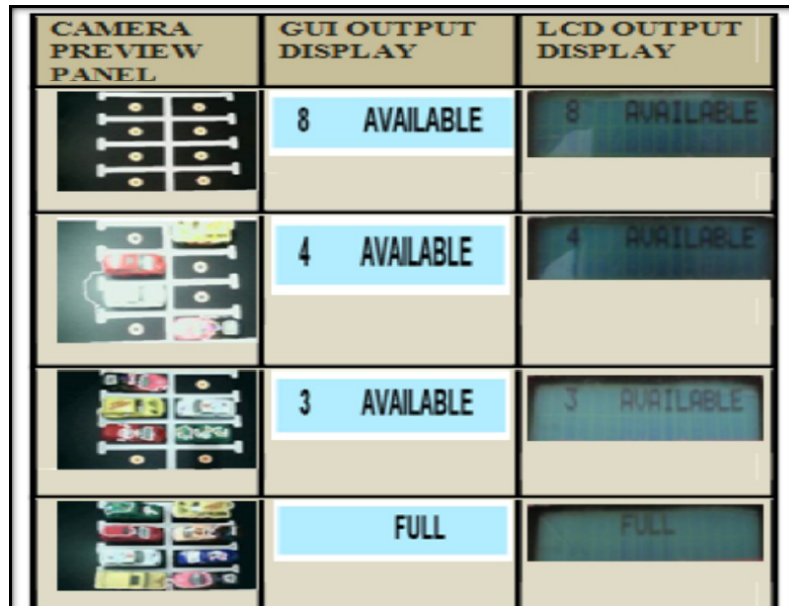
Figure 3.9: Parking géré par un système de traitement des images [15].
