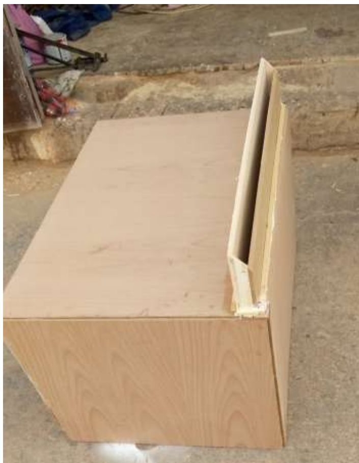
Figure II.19 : La chambre de séchage avant l'addition d'isolation.
