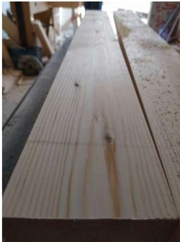
Figure II.9 : L'état de surface du bois après le dressage et le découpage
