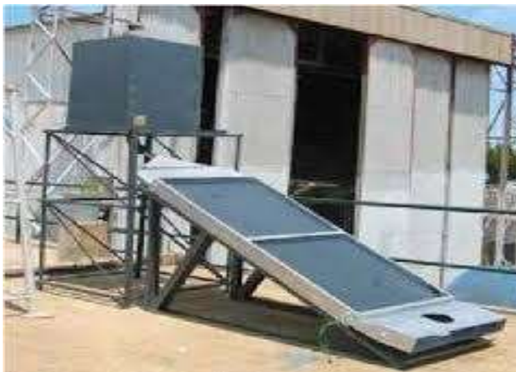
Figure I.11: Séchoir solaire indirect destiné au séchage des PAM, réalisé au CDER (Boulemtafes and Benaouda 2006) [18].
