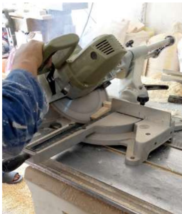
Figure II.10 : Découpage des angles 45°
