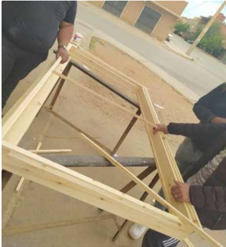
Figure II.15 : Le montage du cadre « supérieure et inférieure » de l'absorbeur
