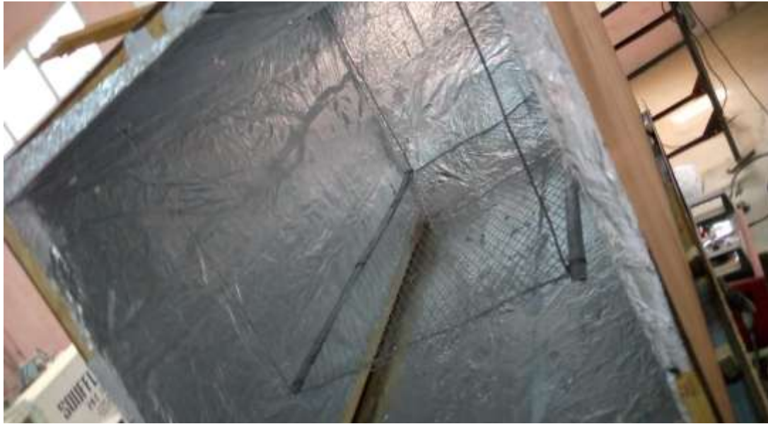
Figure II.21 : L'intérieur de la chambre de séchage après l'addition des isolant « plaque de polystyrène e= 20mm + papier aluminium »
