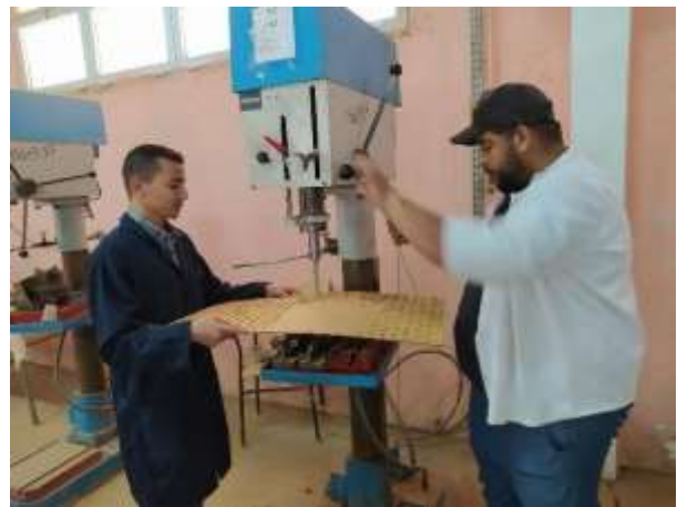
Figure II.22 : Perçage de la plaque de distribution de l'air
