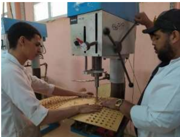
Figure II.22 : Perçage de la plaque de distribution de l'air
