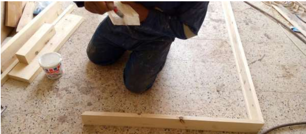
Figure II.12 : Le montage de cadre de l'absorbeur
