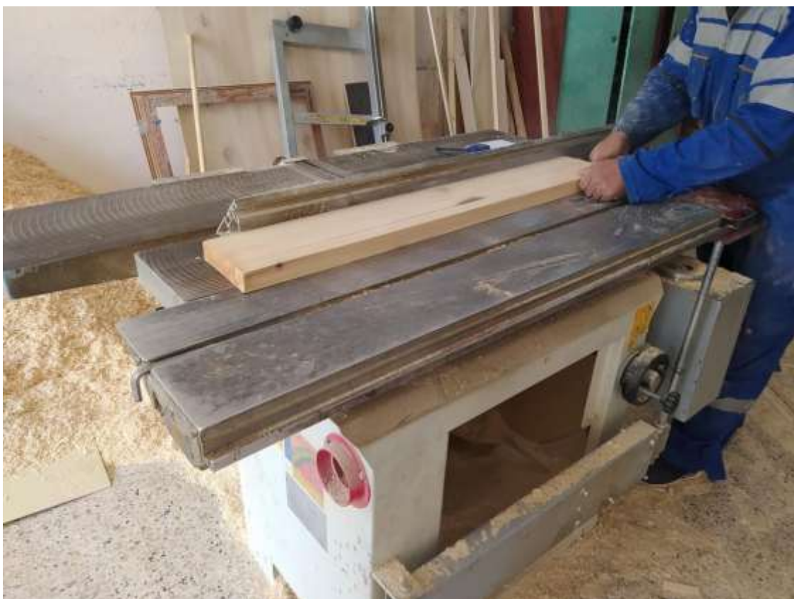
Figure II.8 : Découpage des baguettes de bois selon les mesures
