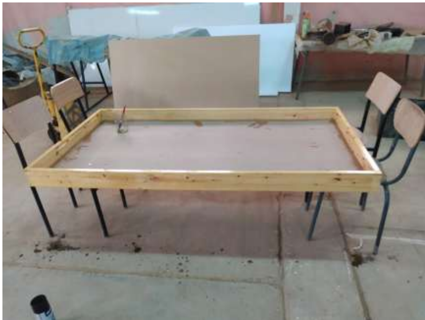
Figure II.16 : Le cadre inférieure du panneau avec une contre plaquée de l'épaisseur de 3.6mm et l'huile
