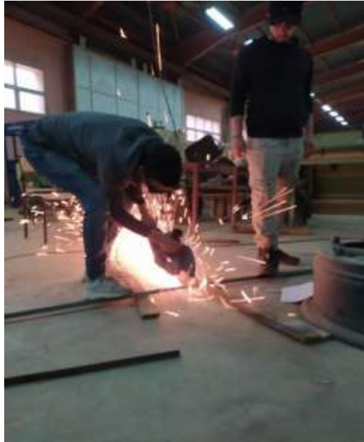
Figure II.23 : Le découpage des cornières et de tube carré
