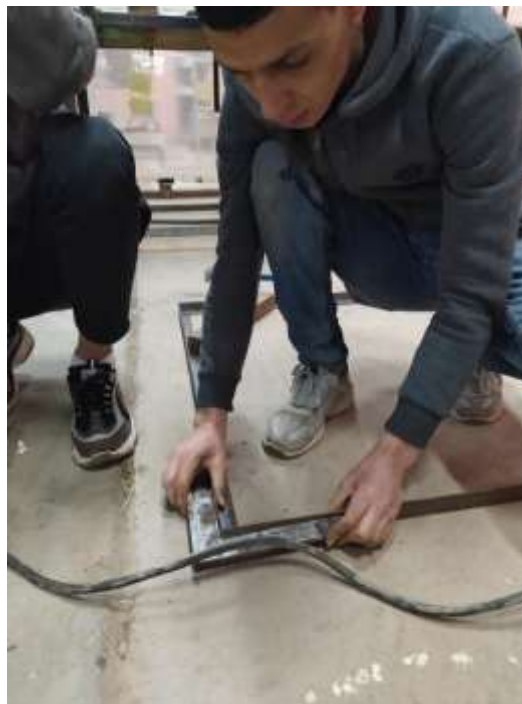
Figure II.24 : Utilisation de l'équerre pour avoir une bonne finition
