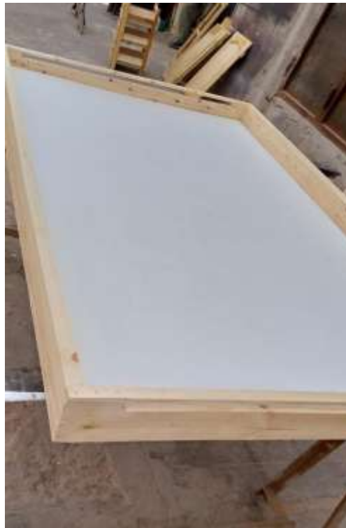
Figure II.17 : L'addition du premier isolant « une plaque de polystyrène 40mm »
