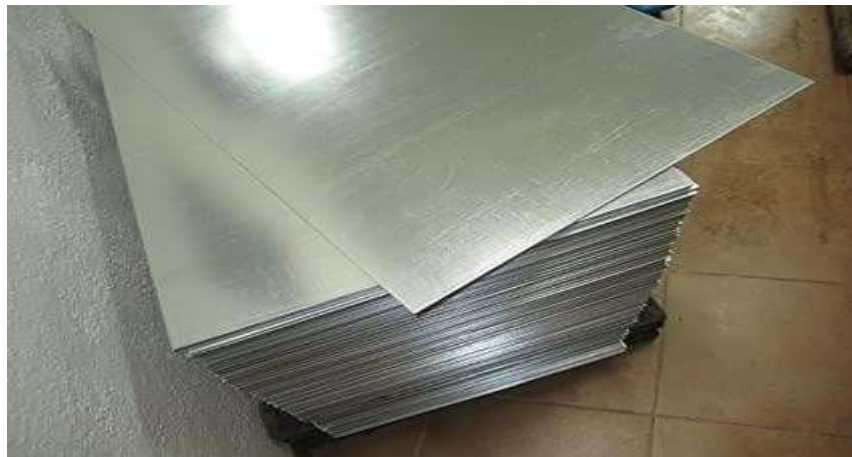
Figure II.4 : Tôle galvanisée e=1.5mm [8]
