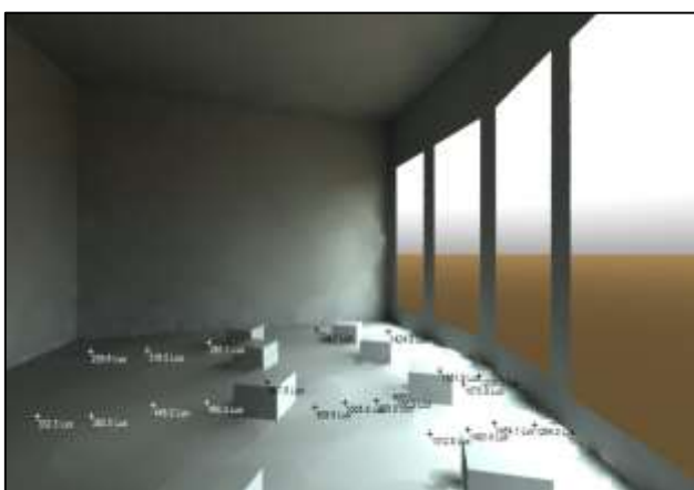
Figure V.32 : Mesure de niveau d'éclairéme nt à des points différents à ciel dégagé. Cas initial en hiver. à 15 h Source : Auteur
