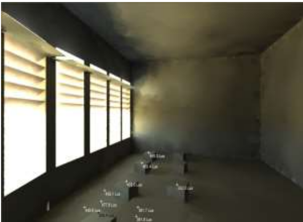
Figure V.41 : Mesure de niveau d'éclairément à des points différents à ciel dégagé. Cas amélioré en été. à 09 h Source : Auteur
