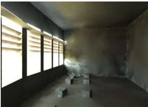
Figure V.43 : Mesure de niveau d'éclairage à des points différents à ciel dégagé. Cas amélioré en hiver. à 09 h Source : Auteur
