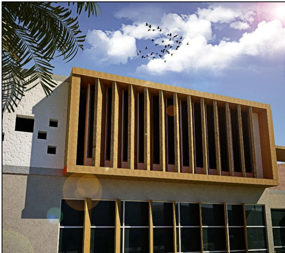
Figure X. 30 : Les brises soleil verticaux (Source : Auteurs).
