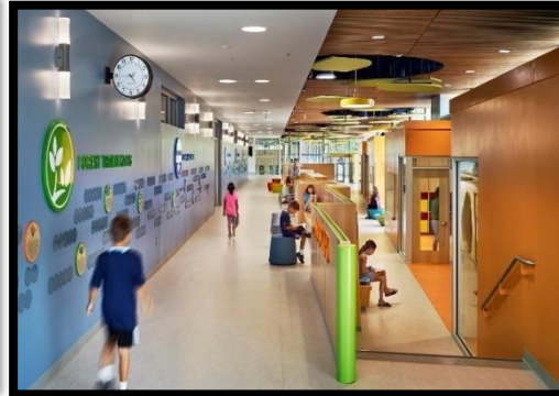
الشكل ا. 31 : انابيب ضوئية لإضاءة الممرات
