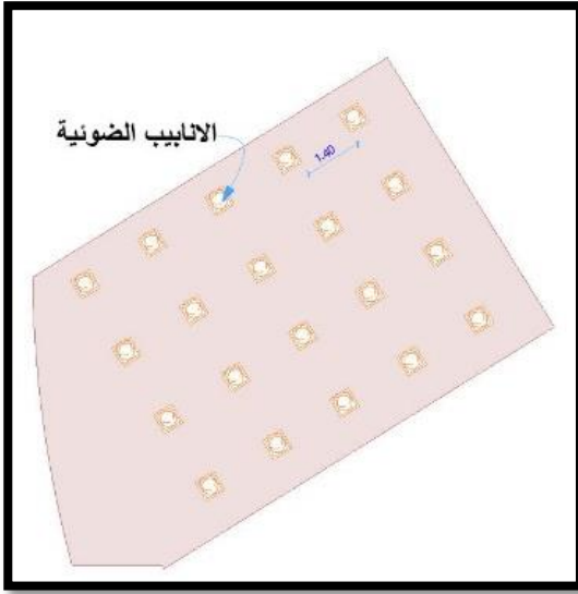
الشكل 14 .V.I : طريقة توزيع الانابيب الضوئية
