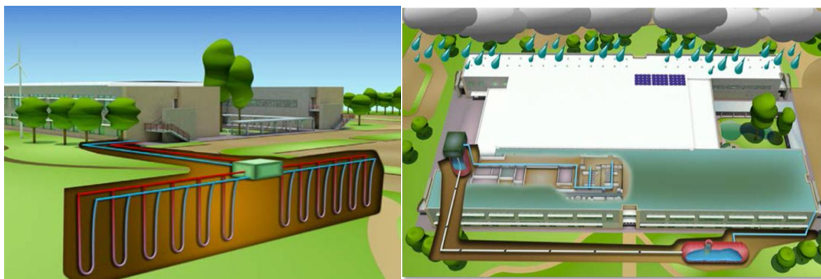
Figure I-47: la géothermie et collecte des eaux pluviales.
