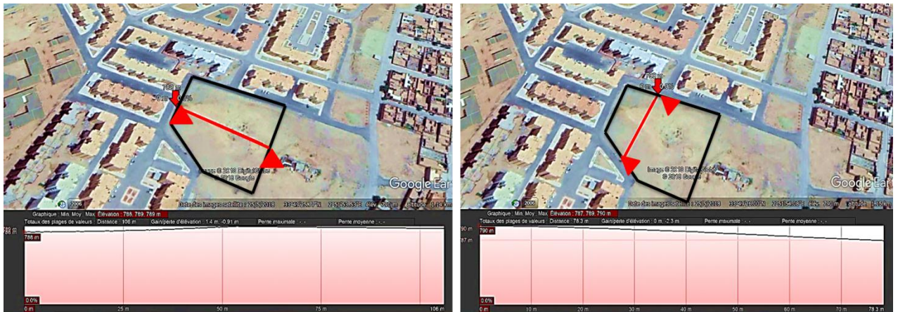
Figure II-23: Coupe topographie longitudinale et transversale du terrain.
