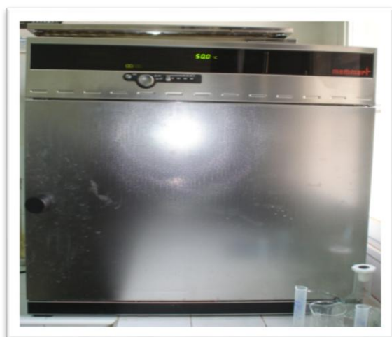
Figure 08: Etuve à circulation d'air (original.2016)
