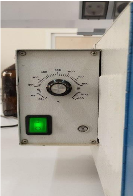
Figure 10: fixe la température a 800 c
