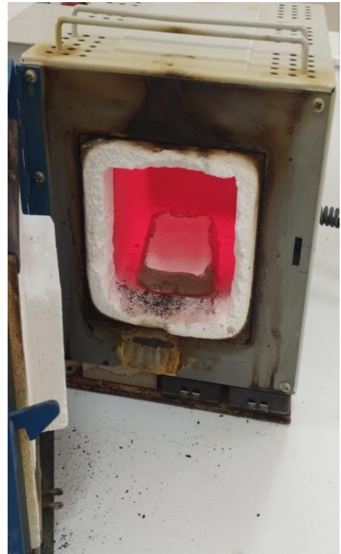
Figure 9: refroidissement des échantillons dans le four
