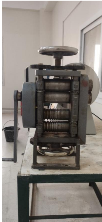
Figure 4 : dispositif de laminage dans le laboratoire de mécanique
