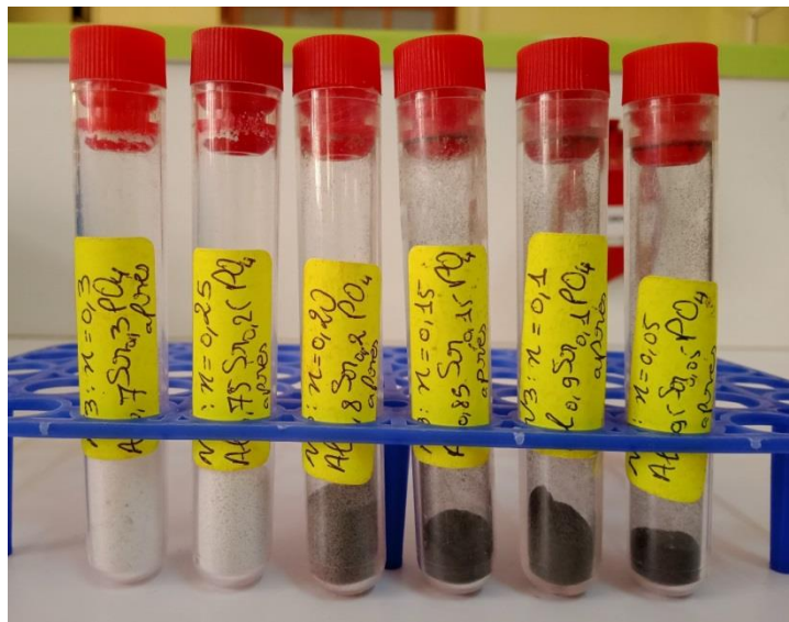
Figure III.7: Photographies des différentes poudres de solution solide \text{Al}_{(1-x)}\text{Sr}_x\text{PO}_4 avant et après la calcination.
