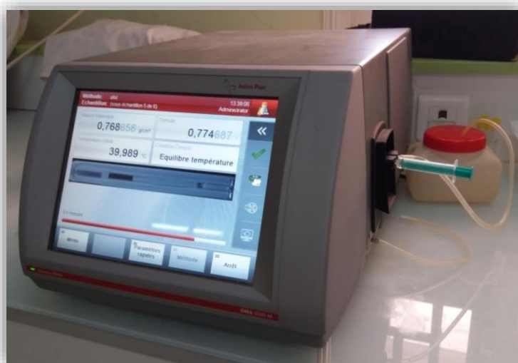
Figure II.1. Photo du densimètre Anton-Paar DMA 5000 utilisé pour les mesures des densités.
