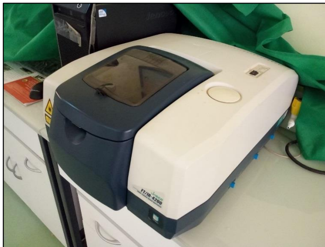
Figure II.22 : spectrophotomètre jasco FT/IR-4200
