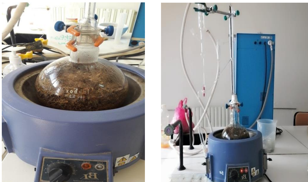
Photo 08 : Appareil Clevenger d'extraction des huiles essentielles par hydrodistillation ( Photo personnelle, 2020 ).
