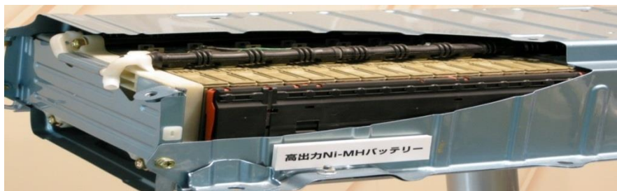
Figure II.12 : Batterie NiMH de Toyota Prius 2 ème génération (1,3 kWh). [II.14]
