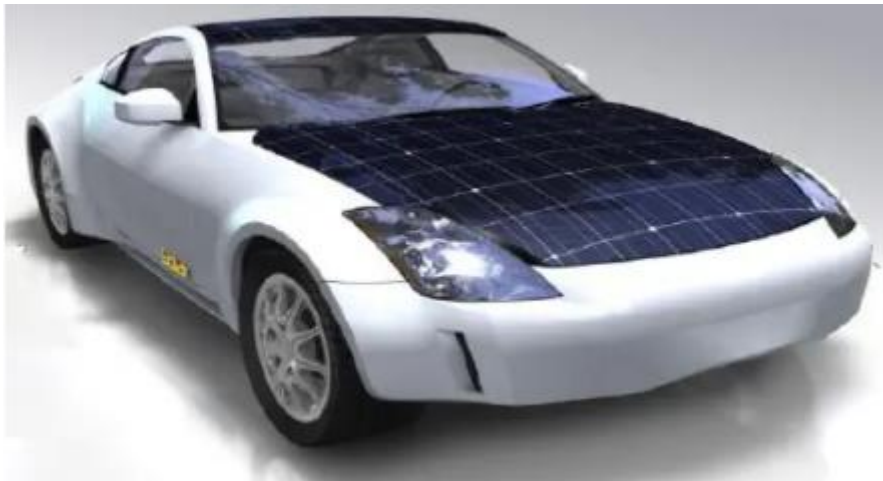
Figure III.08 : Le panneau photovoltaïque de la voiture solaire. [III.02]
