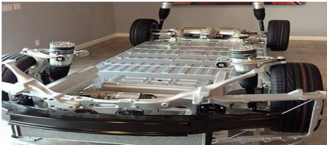
Figure II.11 : Protection en aluminium enveloppe le pack de batterie. [II.12]
