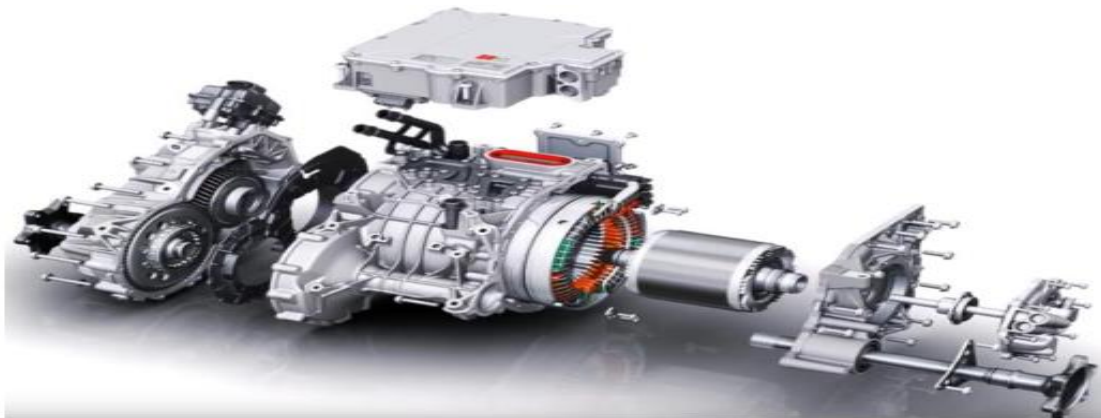
Figure II.28 : Groupe motopropulseur Audi APA250. [II.22]
