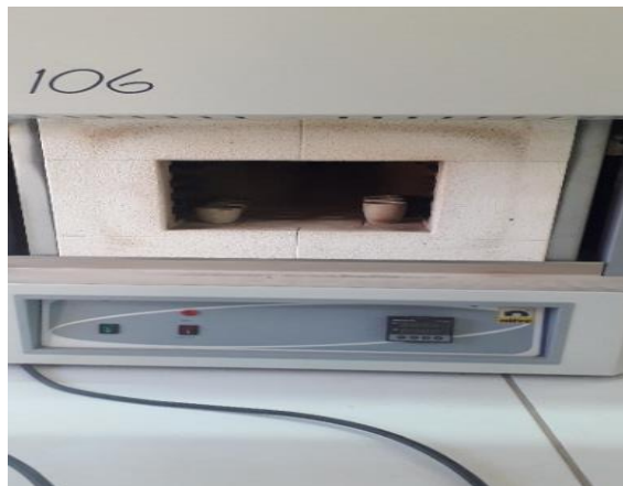
Photo N°7 .Matériel utilisé pour les mesures de matières organique. (Cliché Aouissi AH Février 2020).
