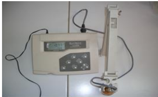
Photo N°4 .Mesure de la conductivité électrique (CE) ; (Cliché Aouissi AH Février 2020).
