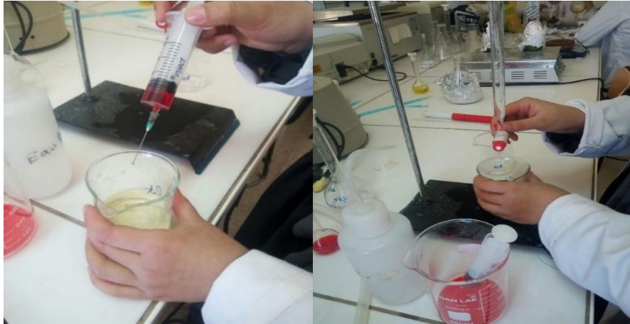
Figure.14. Phase de titration par Ajouter des gouttes de méthyl rouge puis la titration par l'acide chlorhydrique Hcl à 0.2 N ( Original ).
