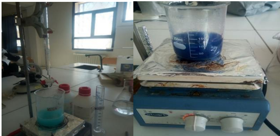
Figure.11. L'ajout des dilutions des fromages par burette sur le mélange des solutions A et B de la liqueur de Fehling ( Original ).
