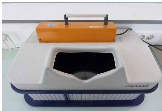
Figure 3.12 : Chambre UV forte puissance type CAMMAG.
