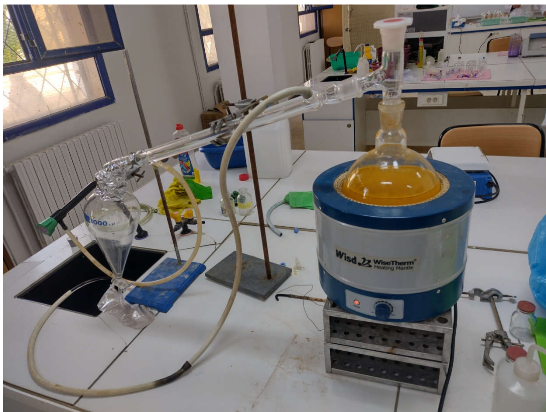
Figure 08 : Montage d'extraction par hydrodistillation d'huile essentielle de curcuma
