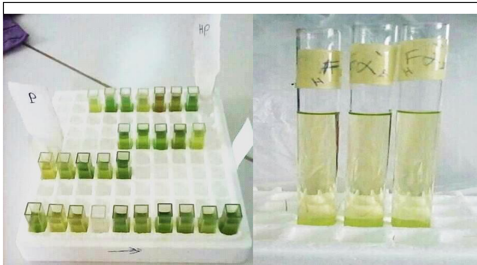
Figure 08 : Photos montrant l'augmentation de l'intensité de couleur selon la concentration de chlorophylle dans la solution (Originale.2019).
