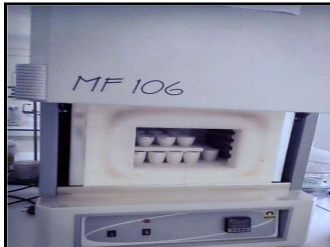
Figure 07: Détermination de la matière organique par incinération (Originale.2019).
