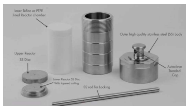
Fig.26. Schéma représentant l'autoclave
