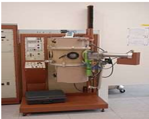
Fig. 17a). Schéma de system d'évaporation sous vide
