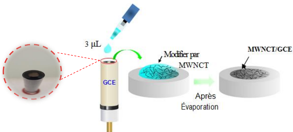
Figure.II.3 Protocole schématique de la préparation de MWCNTs/GCE.
