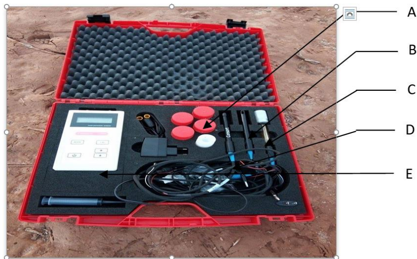
A : Solution à calibrage. B : Sonde à oxymètre. C : Sonde à pH. D : sonde du conductimètre. E : Ecran du multi- paramètre
