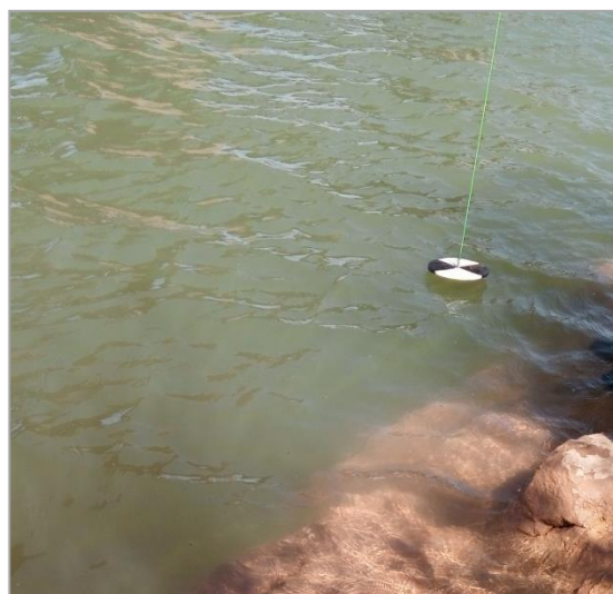
Figure 16 : Mesure de la transparence par disque de Secchi (Originale, 2017)
