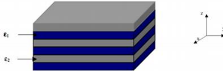
Figure II .2 Unidimensionnel, empilement de couches de permittivités différentes.
