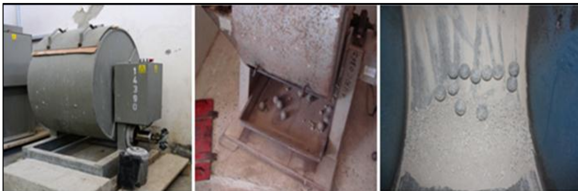
Fig. IV. 5: Essai Los Angeles
